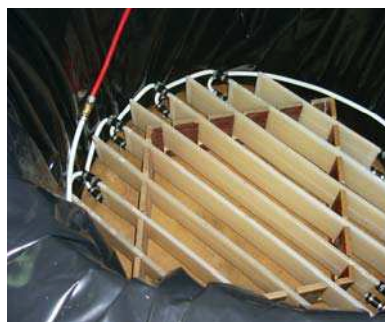
Rys. 2. Wymiennik panelowy. Całkowita dł. paneli 8,48 m, pow. wymiany 2,63 m 2 , dno 1,13 m 2 . Fig. 1. Panel heat exchanger. Overall length of panels – 8,48 m, exchange area 2,63 m 2 , bottom – 1,13 m 2
