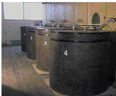
Rys.1 Reaktory cieplne. Średnica – 120 cm, wys. – 100 cm, poj. – 1131 dm 3 Fig. 1. Thermal reactors. Diameter – 120 cm, height – 100 cm, cubic capacity – 1131 dm 3
